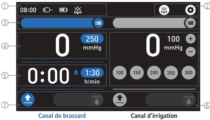
L'affichage principal est réparti en différentes parties : ① Barre d'état, ② Barre de contrôle, ③ Barre de canal, ④ Commande de pression (canal de brassard), ⑤ Commande de temps d'alarme (canal de brassard), ⑥ Commande de pression (canal d'irrigation) et ⑦ Commande de gonflage / dégonflage.
